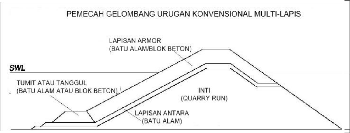
Gambar II.F.25 Pemecah gelombang urugan multi-lapis konvensional
